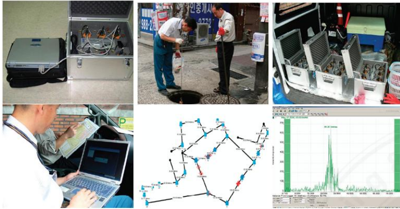
그림 8. 다점형 상관식 누수탐지 시스템을 이용한 누수진단
